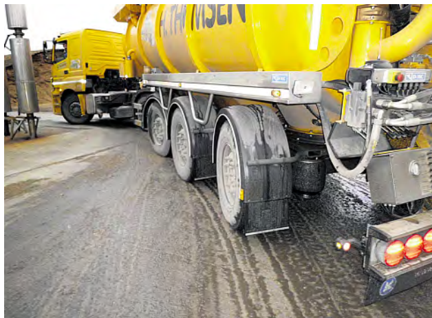
Lenkachsen verringern Schäden an Straßenzufahrten.
