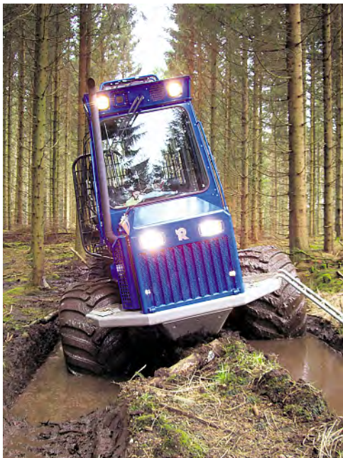
Nasse Gassen halten dem Forwarder nicht stand. Eine mögliche Neigung der Maschine erfordert eine konsequente Gassenbreite von 4 m.
