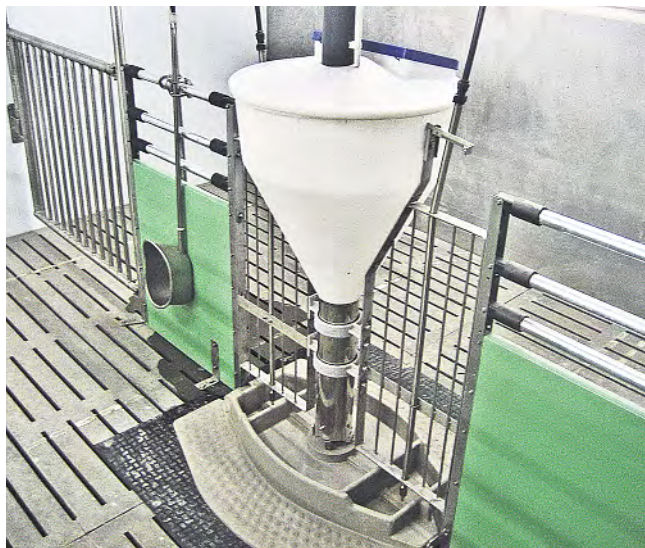
Ein Schutz der Betonspalten durch einen Polymerkranz am Automat und noch zusätzlich eine Gummimatte. Brettprofile und Rohre sind abgedichtet. Das Tränkebecken hat immer die richtige Höhe, damit die Mastschweine sich nicht verletzen.
