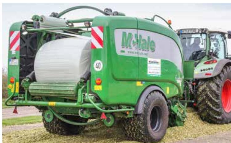
Die modifizierte McHale-Pressen fährt über das auf einer Bodenplatte abgelegte Erntegut und nimmt dieses über die Pick-up auf. Foto: privat
