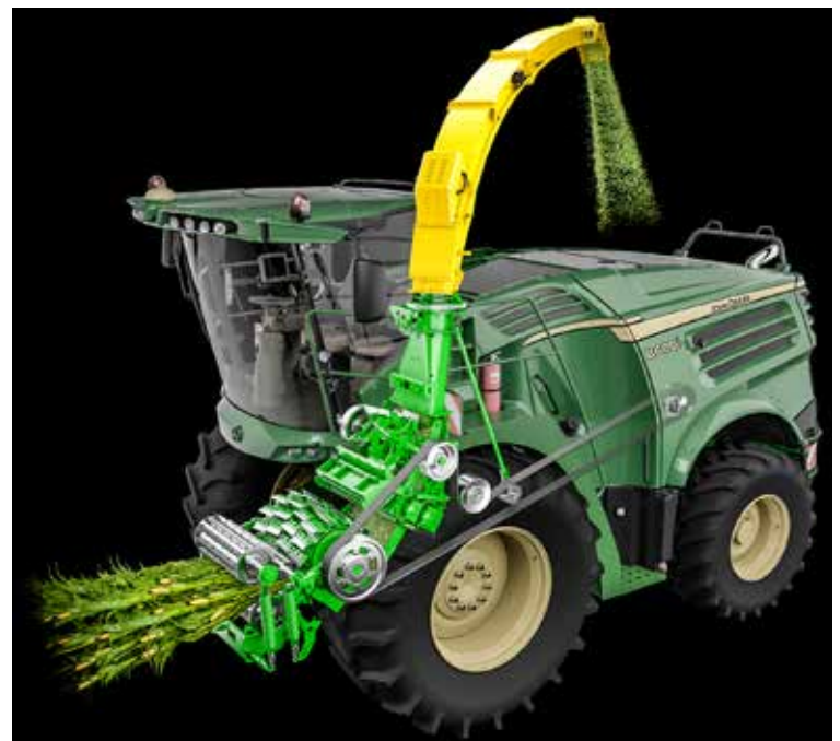
Gutfluss von Mais im Feldhäcksler (vier Vorpresswalzen, Segmentmesserhäckseltrommel, Körnerprozessoren, Wurfbeschleuniger, Auswurfkrümmer mit NIRS-Sensor) Foto: Werkbild
