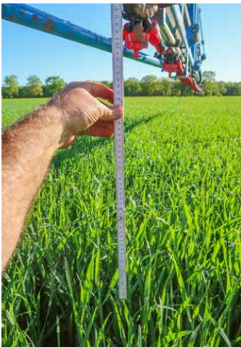
Alle 10 bis 20 cm Gestängehöhe kann sich die Abdrift verdoppeln.
