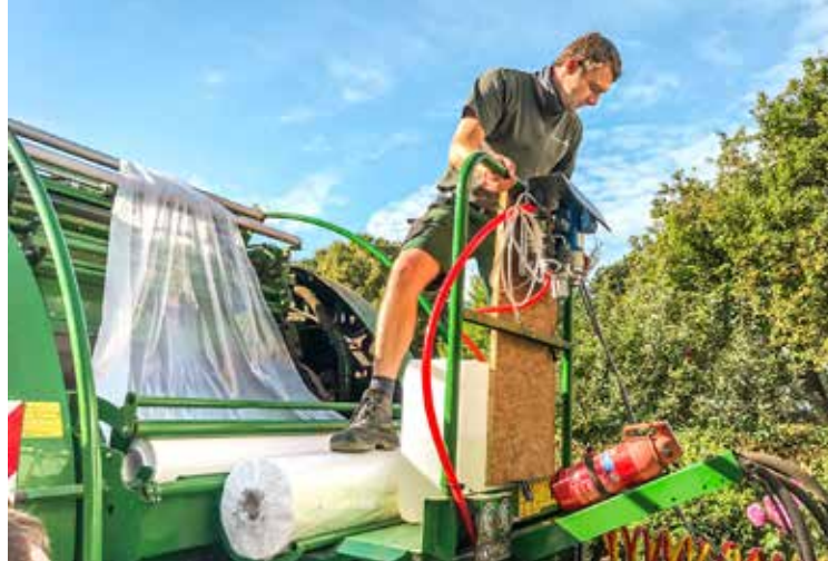
Auch für Ballenpressen gibt es Dosiereinrichtungen, die die Forderung an eine ökonomische Verteilung des Silierzusatzes und Benetzung des Siliergutes erfüllen.
