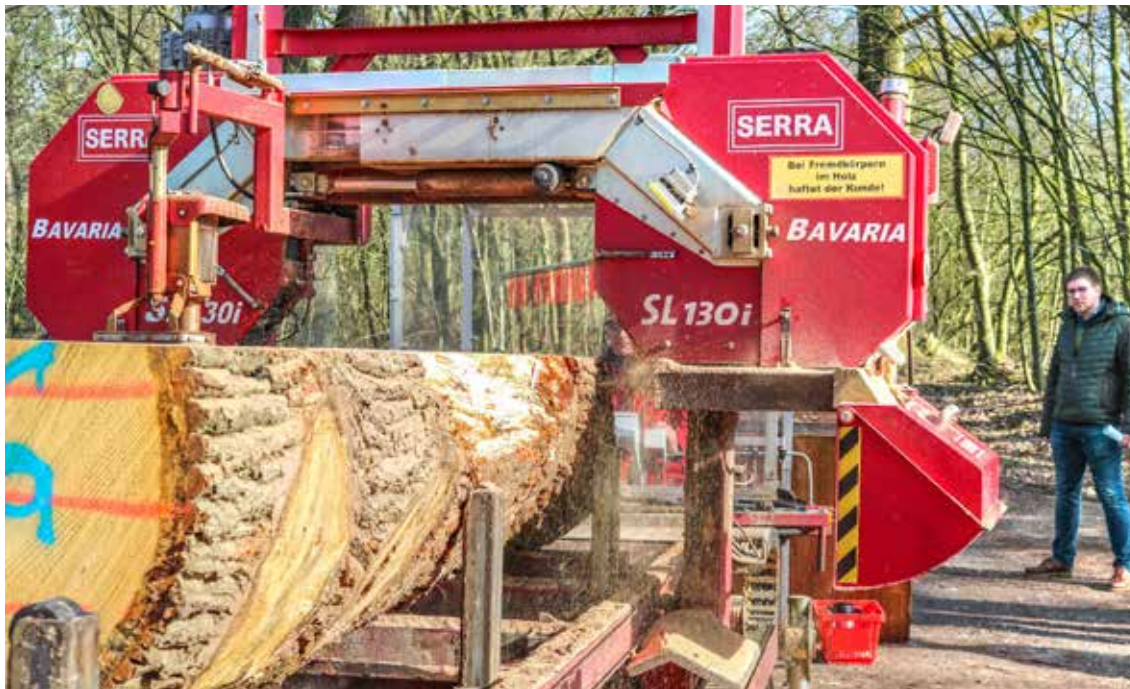
Die mobile Säge von Dirk Schwager aus Jevenstedt fertigt vor Ort Tischplatten aus 3 m langen Eichenstämmen.
