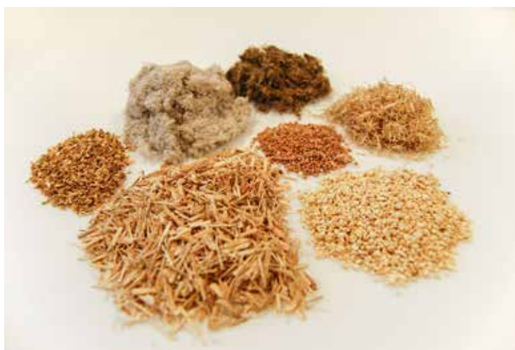
Mögliche Reststoffe aus der Landwirtschaft für Biokunststoffe, zum Beispiel Dinkelspelze, Maisspindeln, Stroh, Miscanthus
