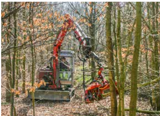
Der mit einem Holzkneifer ausgestattete kleine Bagger legt hier die zu entnehmenden Bäume aus einem 18-jährigen Laubbaumbestand aus Erstaufforstung an die Rückegasse, sodass der Hacker sie später verarbeiten kann.
