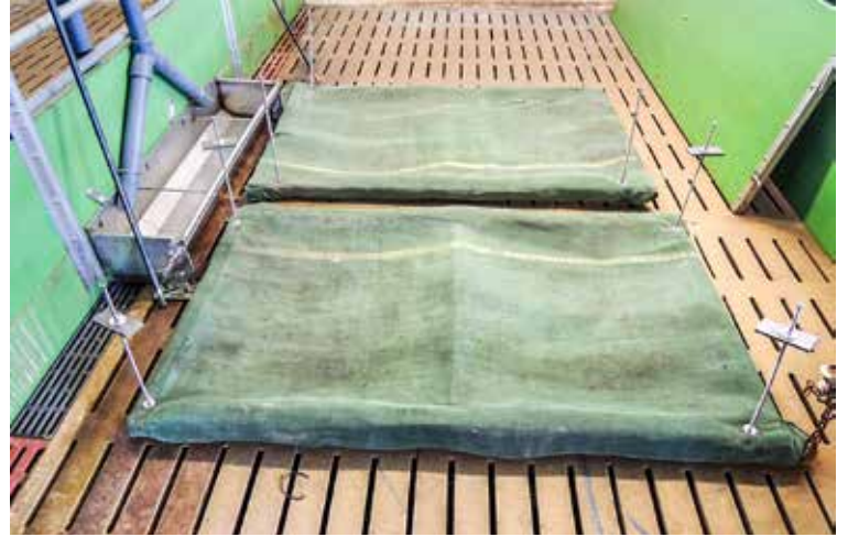
Holzkonstruktion mit Netz zur Ermittlung der Futtermittelverluste
