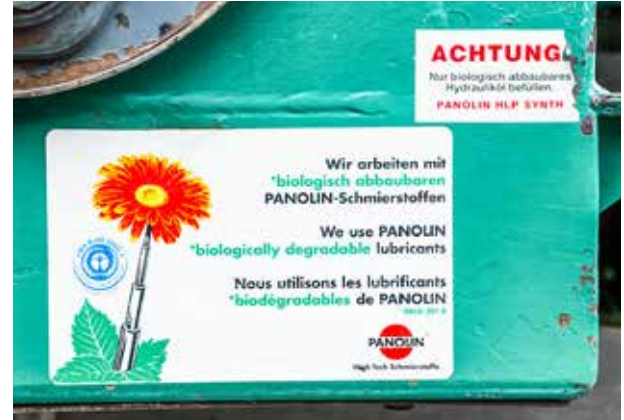
Zum Schutz von Wasser und Boden werden bei der Waldarbeit biologisch schnell abbaubare Kettenöle und Hydraulikflüssigkeiten verwendet.
