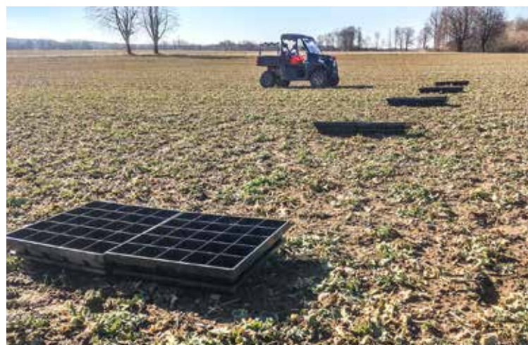
Um Fehler in der Verteilgenauigkeit zu vermeiden, kann das Streubild des Mineraldüngerstreuers durch das Auslegen von Streuschalen auf dem Feld überprüft werden.
