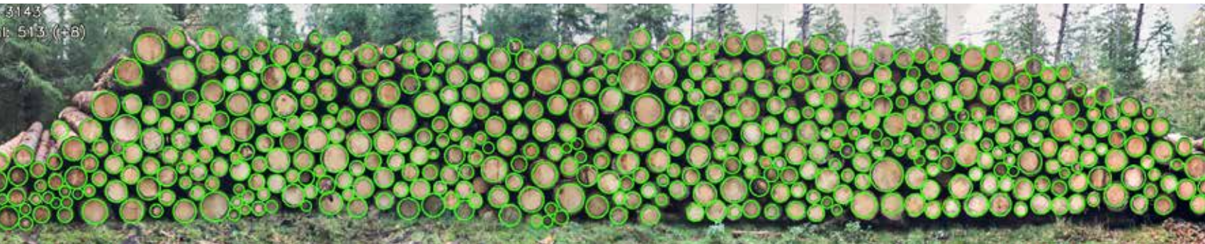
Aufnahme einer fotooptischen Holzvermessung – insbesondere im frischen Zustand werden die Einzelstämme überwiegend korrekt erkannt, sodass nur geringe nachträgliche Korrekturen erforderlich werden. Foto: Ulrich Wulf
