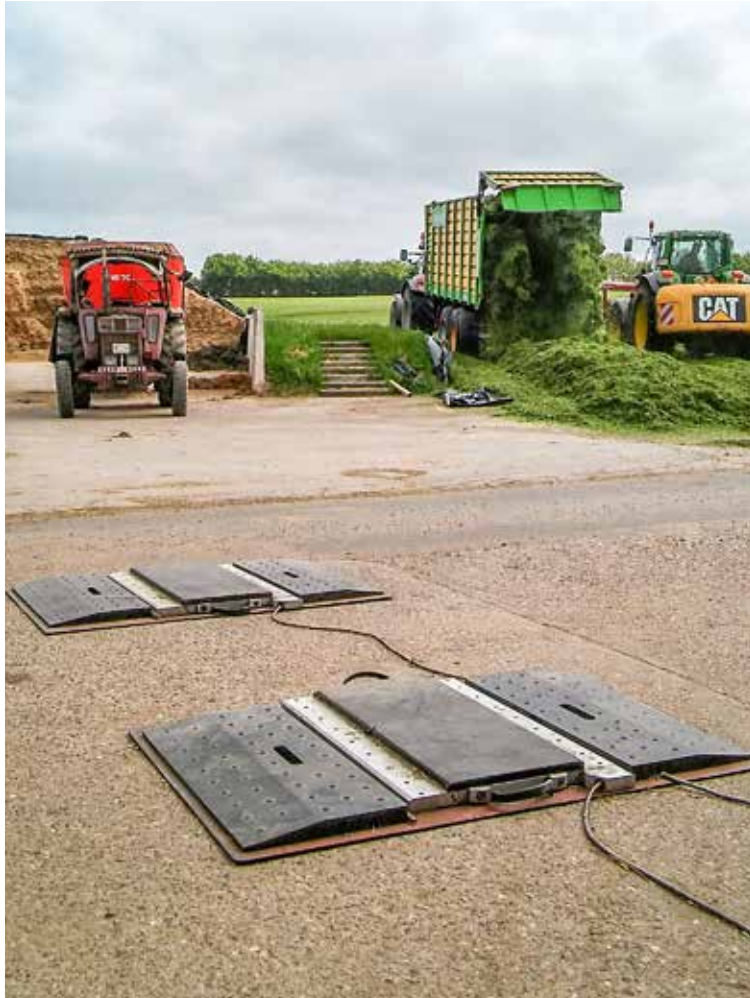
Ein elementarer Baustein in dem Projekt war die Erfassung der Praxiserträge, hier mithilfe einer mobilen Achslastwaage.
