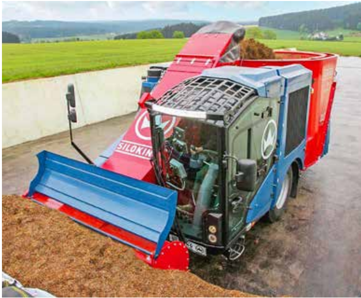
Saubere Silo- und Hofflächen und der bessere Arbeitskomfort bei der Futterentnahme und -vorlage sind Vorteile der selbstfahrenden Futtermischwagen.
