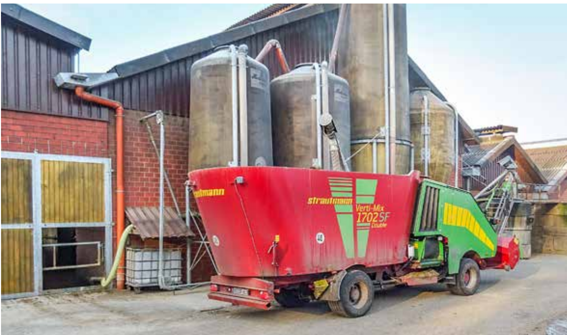
Ob der Selbstfahrer eine Alternative zum angehängten Futtermischwagen ist, muss einzelbetrieblich geklärt werden.
