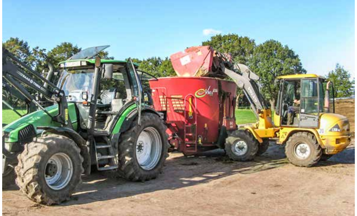
Beim Einsatz eines angehängten Futtermischwagens als Fremdbefüller sind in der Regel ein Schlepper vom Futtermischwagen und ein Befüllfahrzeug erforderlich.
