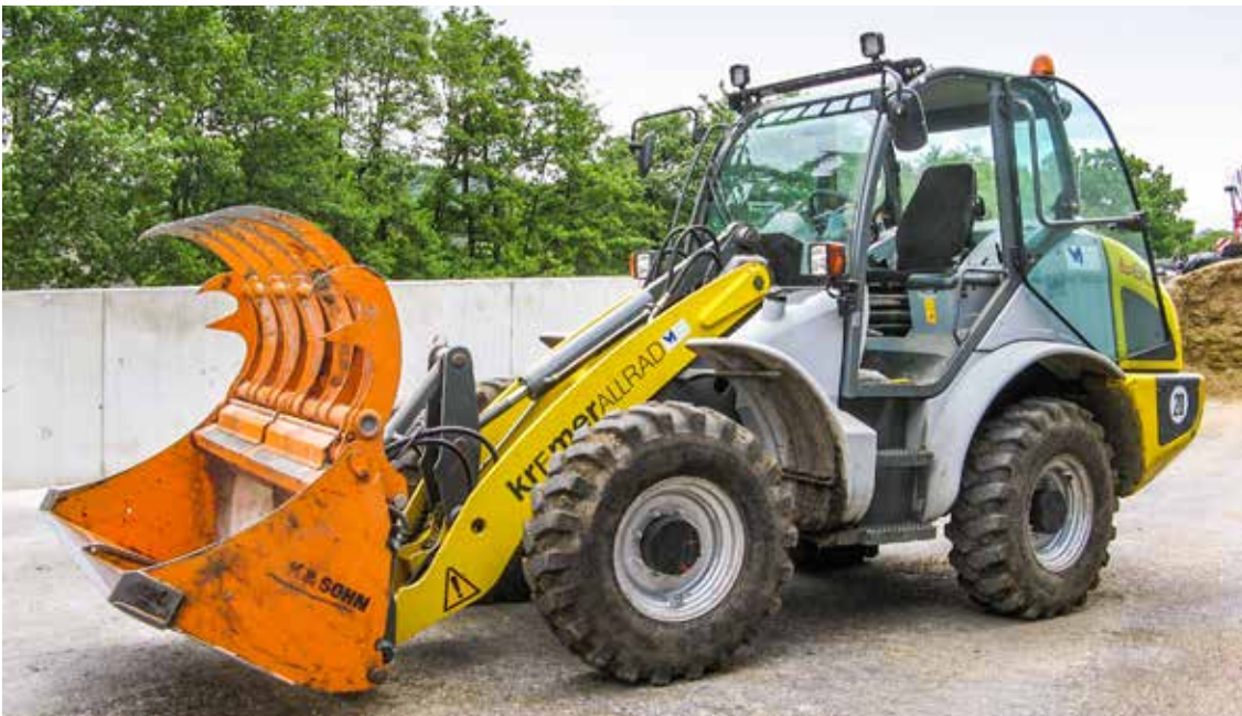
Bei der Fremdbefüllung ist bei größeren Schaufeln oder Zangen die höhere Belastung zu bedenken, sodass dann häufig ein Radlader besser geeignet ist als ein Schlepper.
