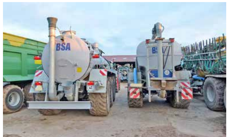
Bei größerer Hof-Feld-Entfernung ist ein Zubringerfahrzeug erforderlich. Dazu bieten sich Pumptankwagen an, wenn diese auch das Feld befahren sollen. Bei größeren Entfernungen sind Lkw vorteilhaft.
