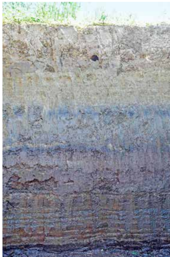
Bodenprofil einer älteren Dwogmarsch: Zu erkennen ist ein mächtiger Moorkörper, der in verschiedenen Zeitepochen mehrfach überschlickt wurde. Durch die dunkle Färbung lassen sich zwei fossile Oberbodenhorizonte erkennen. Fotos (2): Prof. Conrad Wiermann
