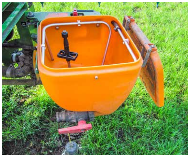
Einfüllschleusen helfen beim sicheren Befüllen der Pflanzenschutzspritze. Hier können entleerte Gebinde direkt von innen gespült werden.
