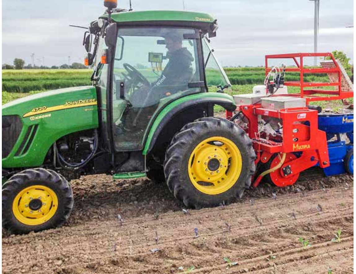
Pflanzmaschine mit Unterfußdüngungseinrichtung beim Pflanzen von Weißkohl auf dem Versuchsfeld Barlt Fotos: Robert Bode
