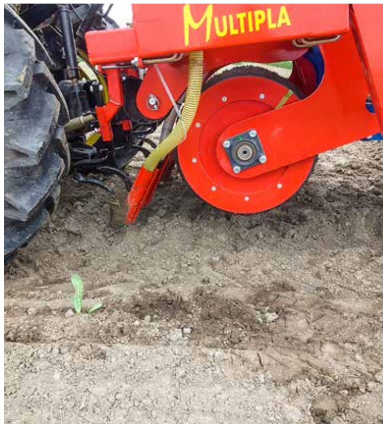
Seitenansicht der Düngungsschare, mit denen sowohl Granulatdünger wie auch Flüssigdünger unterhalb der Pflanzreihe abgelegt werden kann
