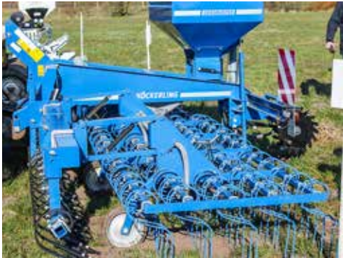
Der Grünlandstriegel mit montierter Nivellierschiene eignet sich zum Einebnen, Narbelüften und Nachsäen.
