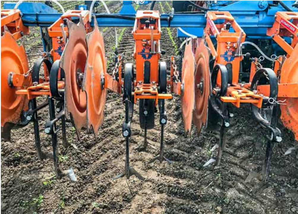
Das Foto zeigt die eingesetzte Hacktechnik. Die Steuerung der Technik erfolgt mittels einer Kamera, welche die Reihen erkennt. Fotos: Detlev Dölger
