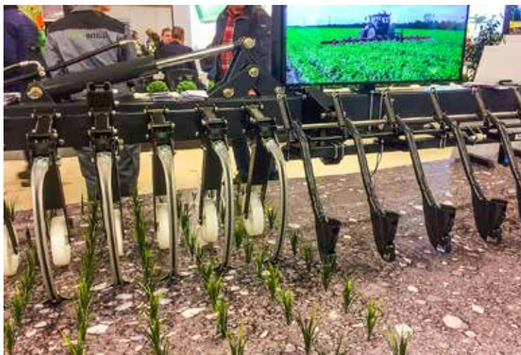
Hack- und Drillschare für den Einsatz auf leichten und mittelschweren Böden (Agro intelligence).
