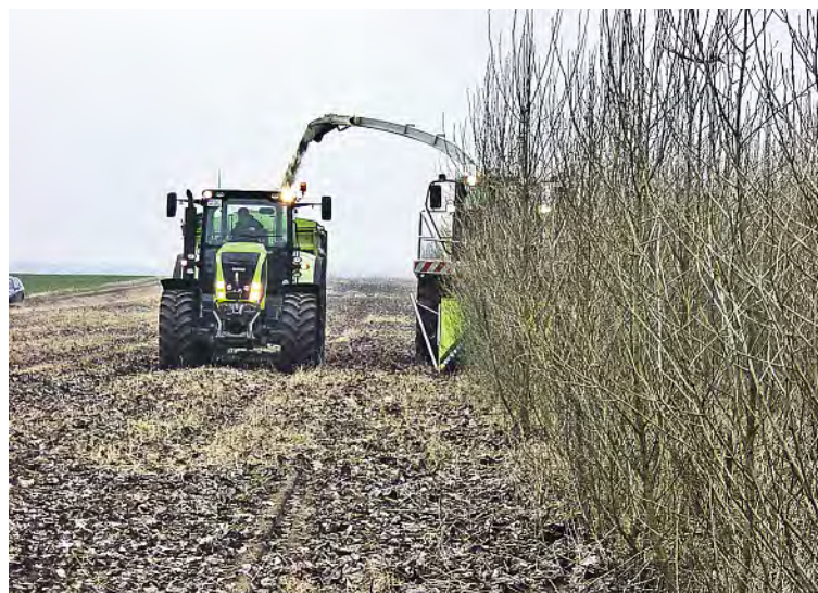
Beerntung einer Pappel-KUP mit einem Feldhäcksler mit Gehölzvorsatz im südbrandenburgischen Cahnsdorf (Februar 2008).
