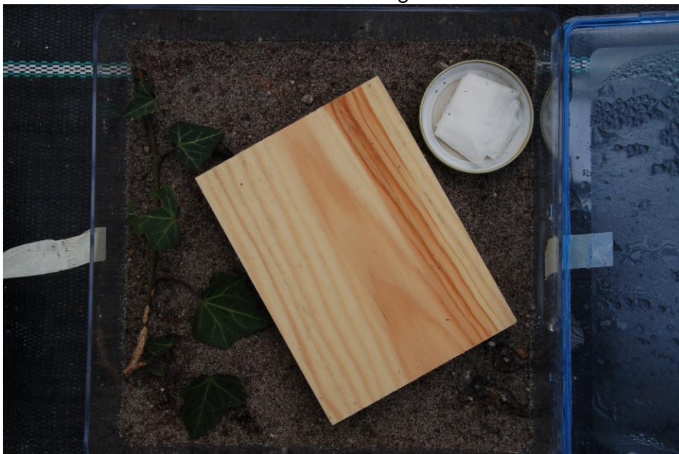
Abb. 2.: Als Versucharena dienten Frischhalteboxen (20 x 20 x 8 cm), in denen eine ca. 0,5 cm mächtige Schicht aus einem Torf-Sand-Gemisch (v:v = 1:1) enthalten war, ein Zweig von Hedera helix 'Woerner' als Futterpflanze und eine kleine Schale ( \varnothing = 4 cm) mit Wasser. In die Boxen wurden jeweils drei Käfer gesetzt. 24 h danach wurden die Holzbretter (13 x 9,5 x 1,5 cm) ausgelegt, auf deren Unterseiten ein Spezialgel mit Steinernema carpocapsae aufgetragen war
