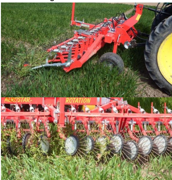
Abbildung 2 Einsatz eines Rollstriegel zur Unkrautbekämpfung (Foto: Krug LKSH)
