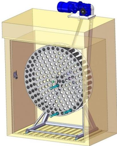
Abbildung 1: Schematischer Aufbau des am ILV weiterentwickelten und aufgebauten Hohenheimer Biogasertests, Wärmeschrank mit motorbetriebem Rotor und Kolbenprober
