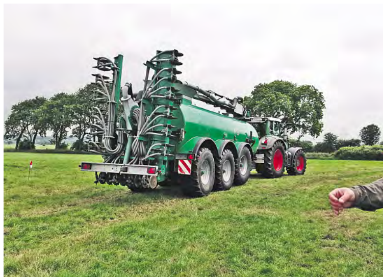
Bodenschonende und emissionsarme Ausbringtechnik fürs Grünland.
