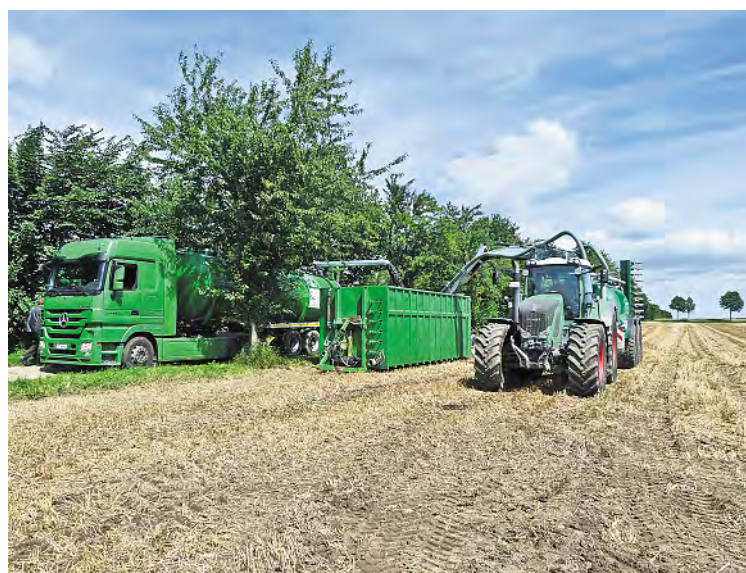
Für die Nutzung von kostengünstigen Straßenfahrzeugen und qualifizierter Ausbringtechnik ist ein Feldrandcontainer erforderlich. Das Verfahren setzt jedoch auch ausreichend einplanbare Feldarbeitstage voraus.
