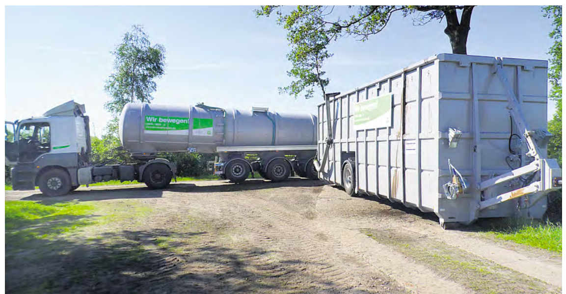
Überladecontainer als mobile Pufferkapazitäten erhöhen die Schlagkraft und sorgen für eine bessere Auslastung der modernen Ausbringungstechnik. Fotos: Peter Hartmann, MR Mittelholstein
