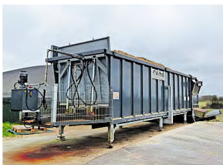
Der Feststoffanteil aus der Gülleseparierung kann problemlos bei Biogasanlagen gelagert werden und Silomaisanteile in der Gaserzeugung ersetzen. Foto: Peter Lausen
