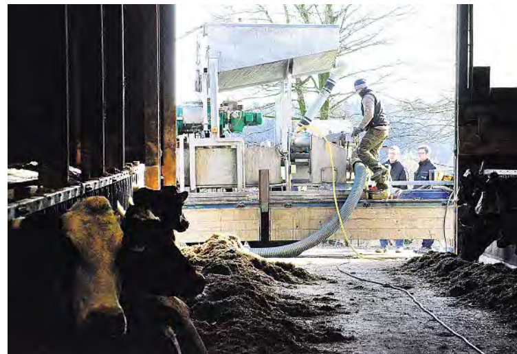
Bei „frischer“ Rindergülle direkt aus dem Stall erreicht der Separator des MR Mittelholstein die höchste Leistung und die höchsten Abscheidegrade.
