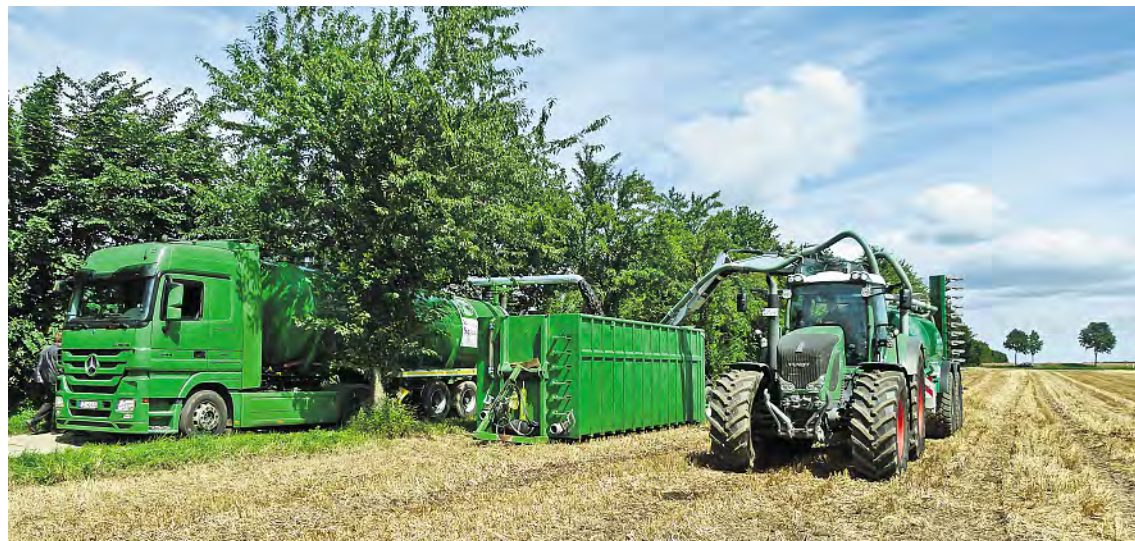
Mit dem Lkw können Gülle und Substratrest kostengünstiger über weitere Entfernungen transportiert werden. Um die Ausbringtechnik auszulasten, ist ein Feldrandcontainer erforderlich.
