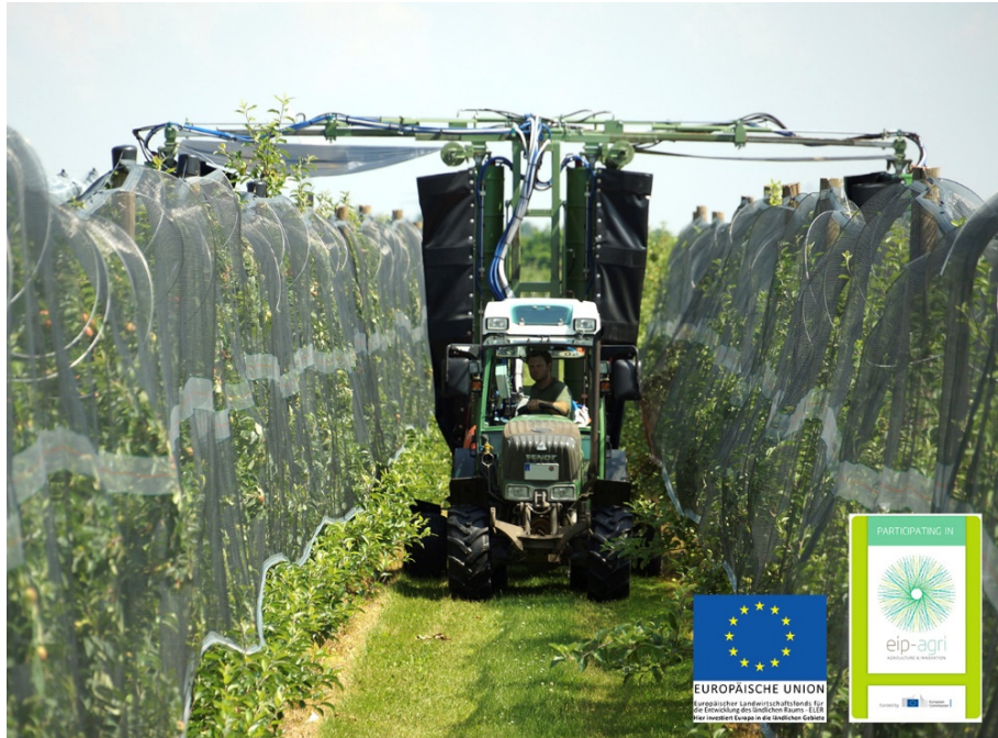
Tunnelsprühgerät OSG NVM2 der Firma Lipco (Foto: Jens-Peter Ralfs)
