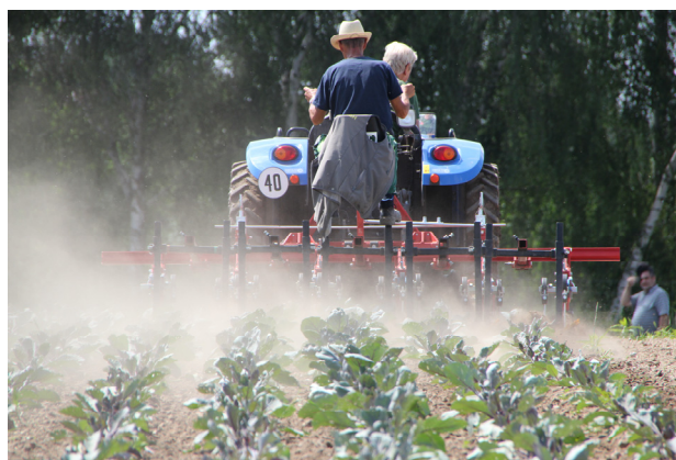
Fingerhacke im Praxiseinsatz - Der richtige Zeitpunkt und die Fahrgeschwindigkeit sind entscheidend.
