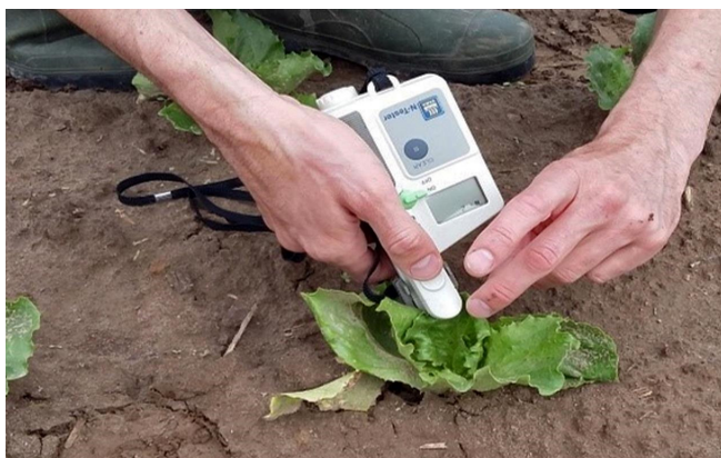
Bestimmung des Blattchlorophyllgehaltes mithilfe des Yara-N-Testers bei Salat
