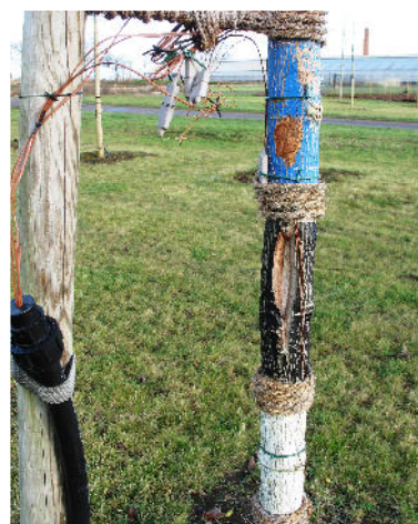
Gewebetemperaturmessung unter Stammanstrichen
