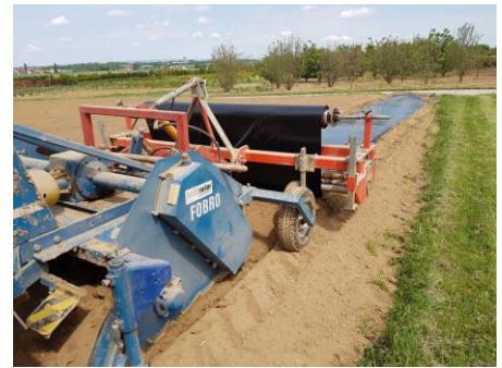
Abb. 3: Gut ist der Einsatz einer Gerätekombination aus Streugerät im Frontanbau und Fräse sowie Folienlegegerät im Heckanbau (Foto: R. Zühlke, Gartenbau Beratungs GmbH)
