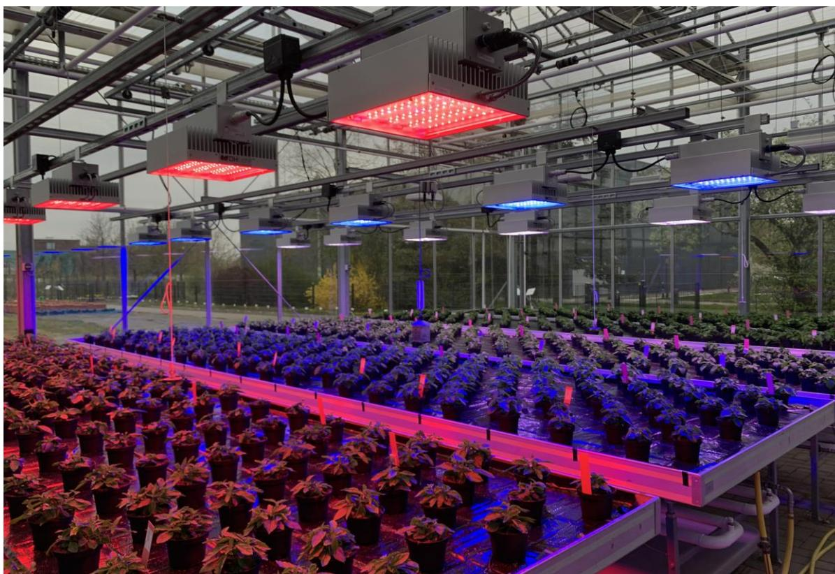
Die neue, leistungsstarke LED-Versuchsanlage im Einsatz bei Beet- und Balkonpflanzen.
