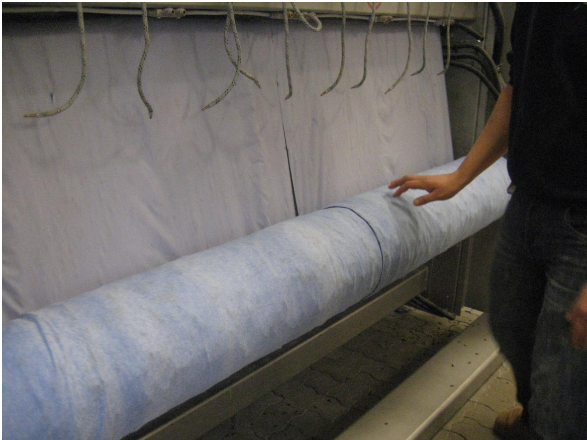
Abb. 1: Zwei aufgerollte Terraseed Papiermatten mit aufgeklebter Saat von Abies nordmanniana auf einer Spezialmaschine bei der Firma Yding Grønt A/S, Østbirk (Dänemark)
