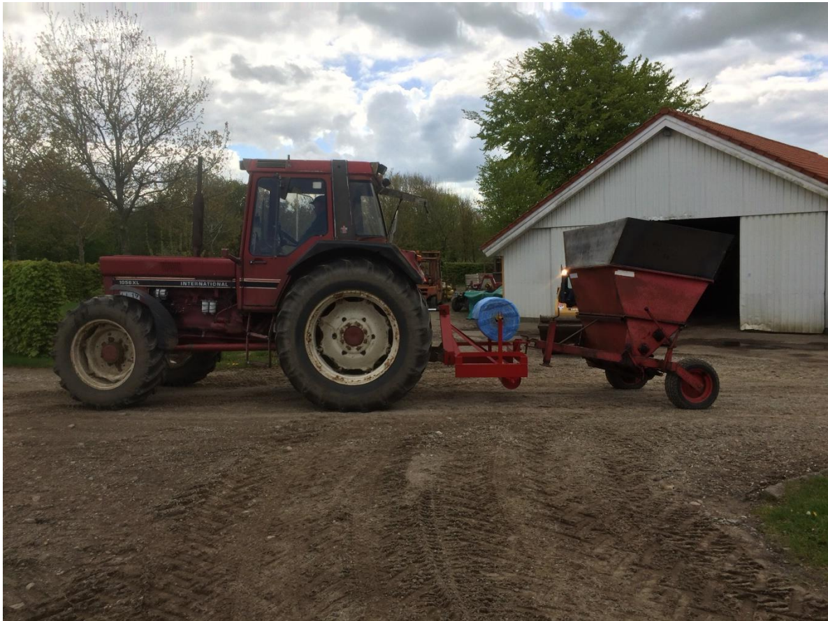
Abb. 2: Schlepper mit Anbaugerät zum Auslegen der Terraseed Matte und angehängtem Egedal Sandstreuer auf dem Weg zum Saatquartier in der Baumschule Bols, Dänemark. Die auf dem Auslegegerät liegende blaue Terraseed Rolle weist eine Länge von 120 m auf
