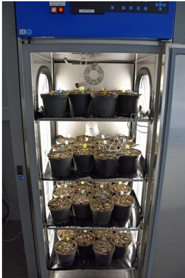
Abb. 3: Klimaschrank mit Mineralboden in Töpfen, auf den vier Düngervarianten aufgestreut wurden
