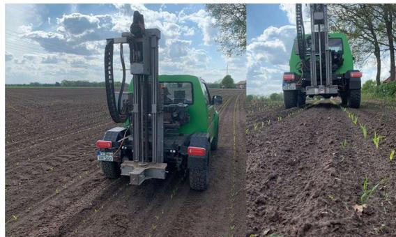
Abbildung 1: Neue Technik zur automatisierten Bodenprobenahme (Foto: S. Trinkies)
