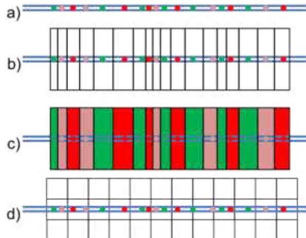
Abb. 90: Ableitung eines Teilflächenrasters aus einzelnen Messwerten
