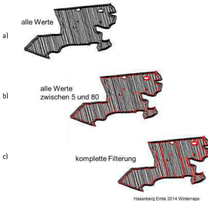
Abb. 83: Filtern von Ertragsrohwerten (rote Punkte werden herausgefiltert)
