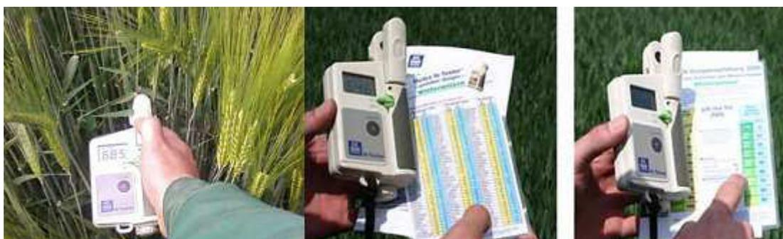
Abb. 54: Verwendung des Yara N-Testers: (links: Messen, Mitte: Sortenkorrektur; rechts: Empfehlung ablesen) (Fotos: Lubkowitz)
