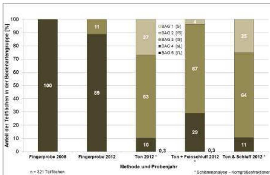
Abb. 9: Bodenartenverteilung über alle Teilflächen nach Bestimmungsmethode.
