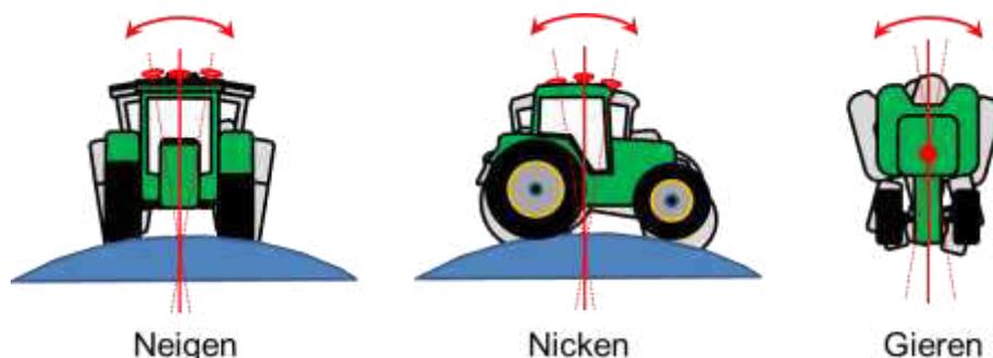
Abb. 6: Bewegung der Maschine und der GNSS-Antenne
