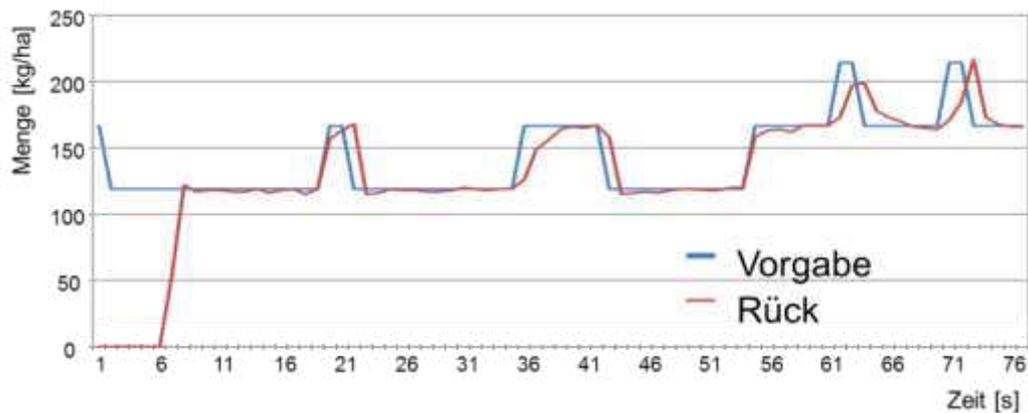
Abb. 43: Rückschrieb der Rapid A600S (6 m)
