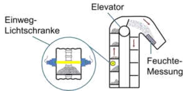
Abb. 80: Volumetrische Ertragsaufnahme (geändert nach Diekhans)
