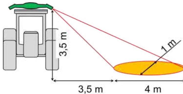
Abb. 53: Geometrie und Messfläche des Yara-N-Sensors
