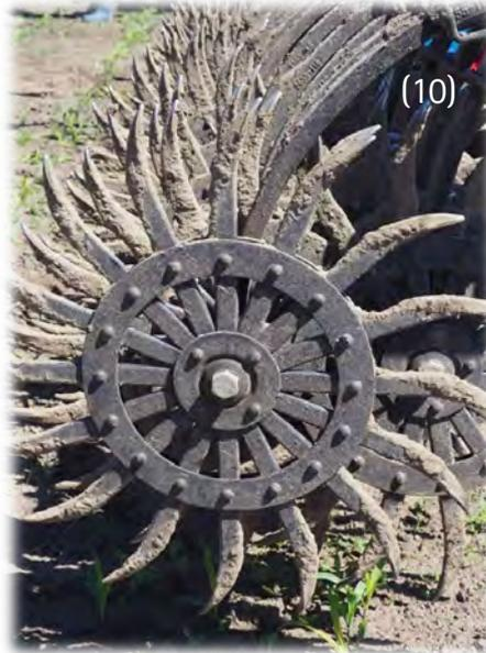
Für das Hacken stehen Rollhacke (10) und unterschiedliche Scharhacken (14) zur Verfügung. Ziel ist das Abschneiden, Herausreißen und Verschütten (11) der Unkräuter.
