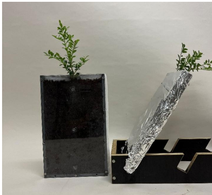
Versuchsaufbau mit Rhizoboxen für pH-Wert Messungen im direkten Wurzelbereich der Pflanzen.
