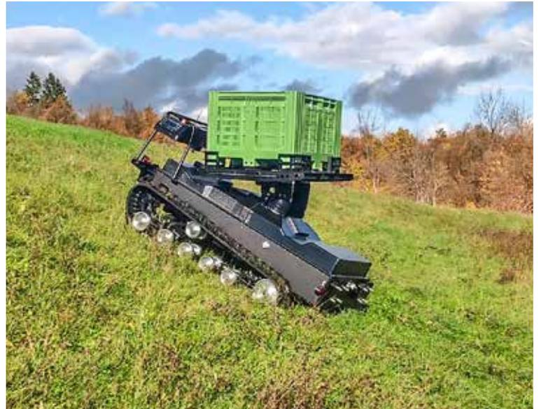
dates für weitere Kulturen sind bereits in Planung, etwa Salate, Spinat und Zwiebeln. Voll beladen wiegt der Roboter 750 kg, er ist bis maximal 10 % Steigung (etwa 5°) einsetzbar.
