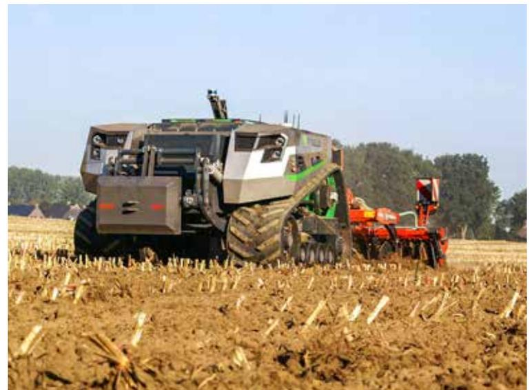
Das von Claas unterstützte Start-up AgXeed setzt auf größere Systeme mit über 150 PS und 6 t Eigengewicht. Damit ist auch Bodenbearbeitung möglich.
