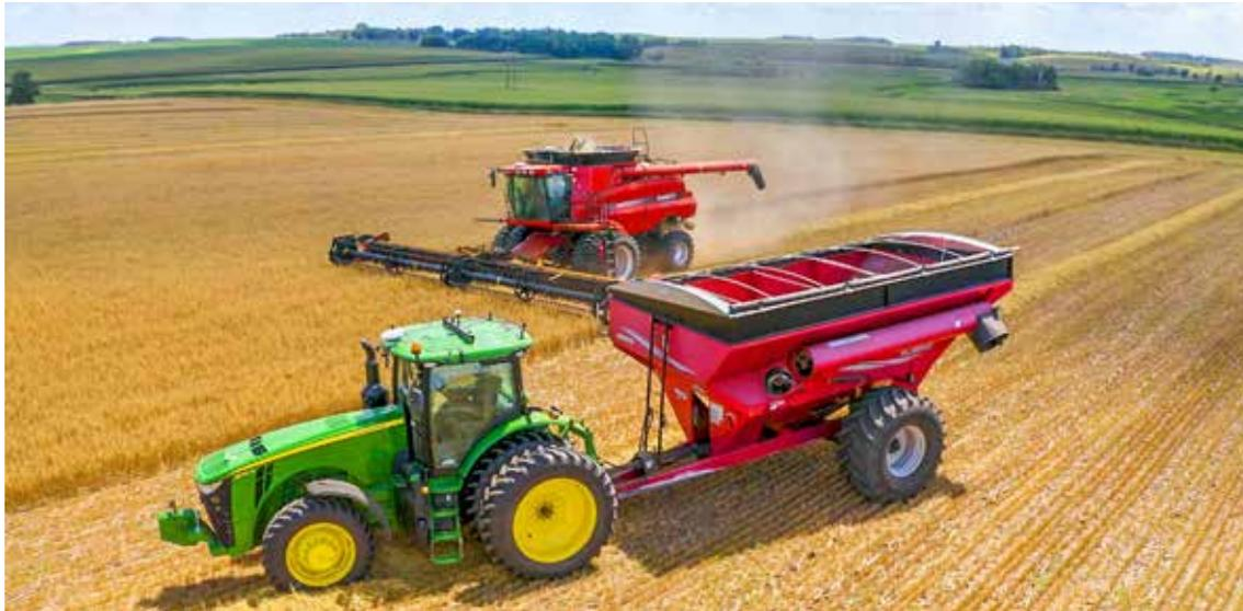
Zwischen automatischem Traktor und Roboter verschwimmen die Grenzen: Raven bietet mit Omnidrive ein System, welches ein Überladewagen-Gespann im Feld automatisch zwischen Mähdrescher und Übergabestelle an der Straße pendeln lässt.
