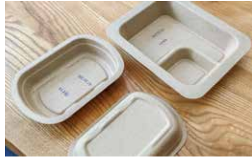
Formteile aus aufgefaserter Schilf und Nasswiesen-Biomasse, ohne Bindemittel, hergestellt von Zelfo Technology und Biolutions
