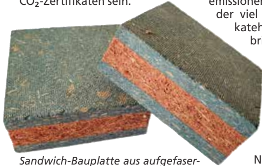
Sandwich-Bauplatte aus aufgefaserter Nasswiesen-Biomasse, ohne Bindemittel, hergestellt von Zelfo Technology
