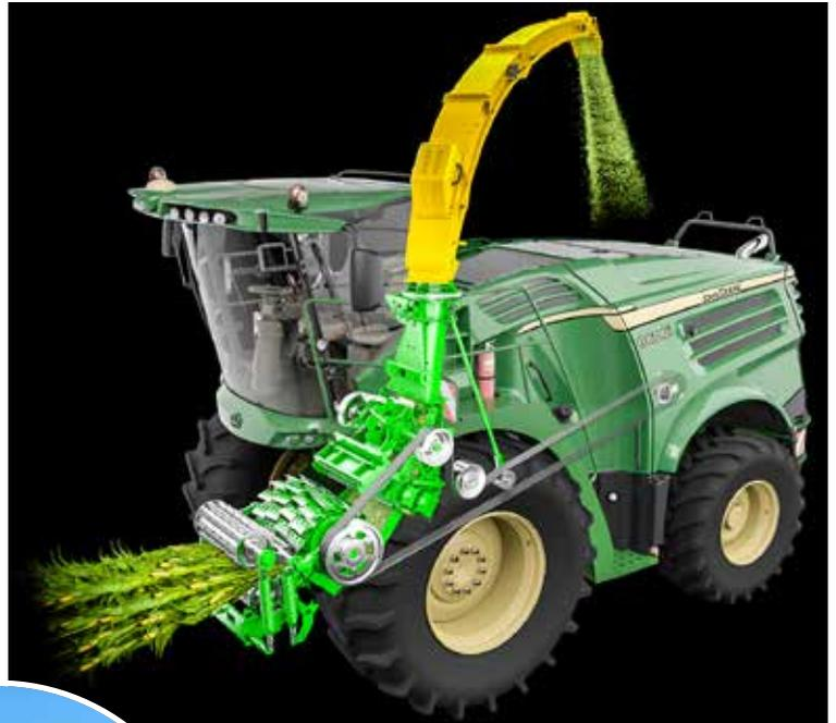
Gutfluss von Mais im Feldhäcksler mit vier Vorpresswalzen, Segmentmesserhäckseltrommel, Körnerprozessoren, Wurfbeschleuniger, Auswurfkrümmer mit NIRS-Sensor
