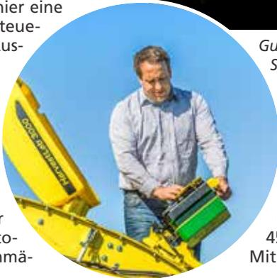
NIRS-Sensor im Auswurfkrümmer, Beispiel HarvestLab3000 der Firma John Deere
