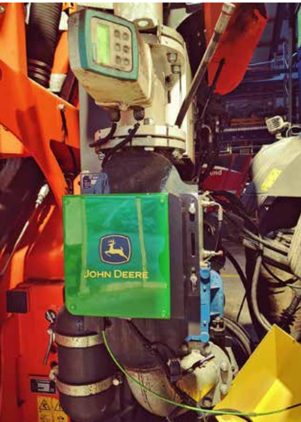
Gülleausbringung mit Verschlauchungstechnik von Schouten und John Deere Harvest Lab 3.000 in Stafstedt
