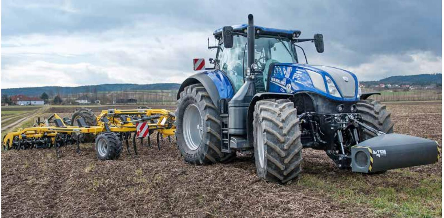
Mit dem TopSoilMapper der Firma Geoprospectors ist es möglich, die Inhomogenität des Bodens während der Bodenbearbeitung in der Fronthydraulik zu messen und die Arbeitstiefe des Anbaugeräts in Echtzeit anzupassen. Foto: Geoprospectors (hfr)
