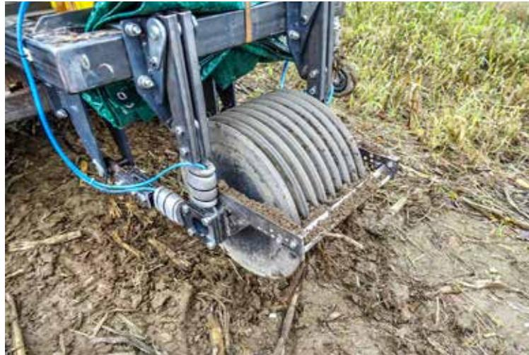
Zusatzmodule „Stoppelheber“ und „Stoppelschlitzer“ als Funktionsmuster im Einsatz (v. li.) Fotos (3): TH Köln
