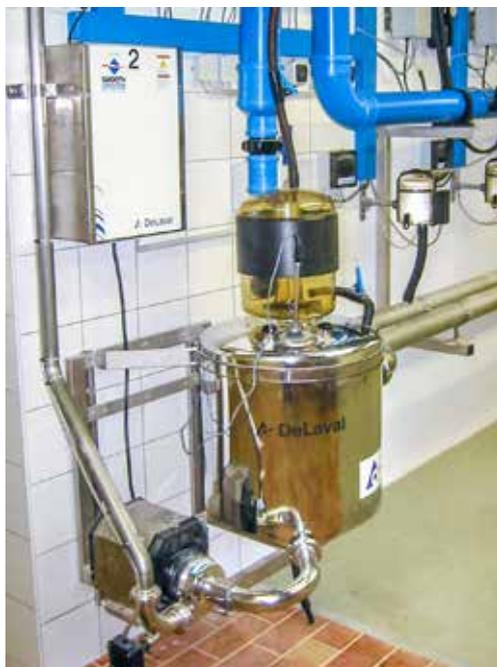
Frequenzgeregelter Milchpumpen fördern die schubweise anfallende Milch gleichmäßig aus dem Melkstand.
