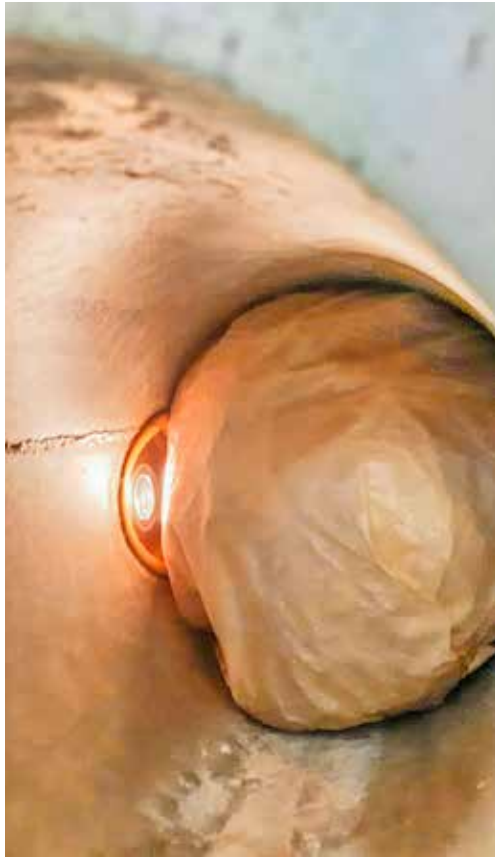
Das Messfenster bringt Licht ins Dunkel: Hier am Beispiel eines Sensoreinbaus in ein 6"-Rohr mit Gülleatrappe (Papierball). Der seitliche Einbau schützt vor Verschmutzungen und Luftblasen. Foto: Rainer Kock
