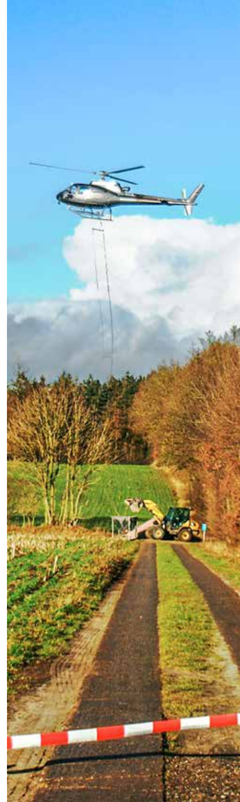
Das Prinzip der Hubschrauberkalkung: Der Kalkstreuere wird nur kurz abgesetzt und mit einer vollen Schaufel des kleinen Radladers beladen.
