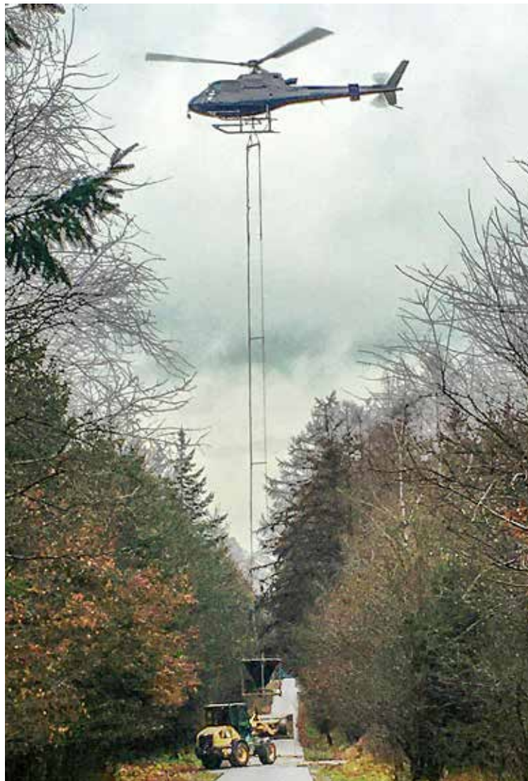
Nicht alle Landeplätze waren einfach anzufliegen. Hier musste der Kalkstreuer auf einer engen Straße abgesetzt werden.
