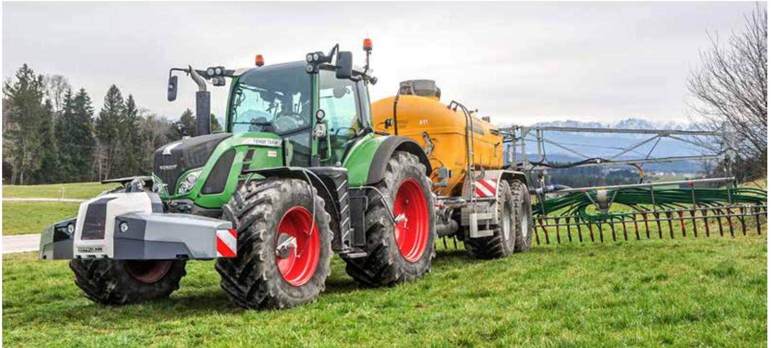
Bei der Gülledüngung auf der Wiese wird mit Schleppschuhen für bessere Düngernutzung, dem Lenksystem für exakten Anschluss, großen, radialen Reifen mit variablem Reifendruck und 1 bar gefahren. Auf der Straße werden, je nach Entfernung, bis 4 bar Reifendruck am Anhänger und 1,8 bar am Schlepper eingestellt. Ohne tiefe Spuren effizient zu düngen, sollte die Leitlinie für hohen Grasertrag und fruchtbaren Boden sein. Foto: Werkbild
