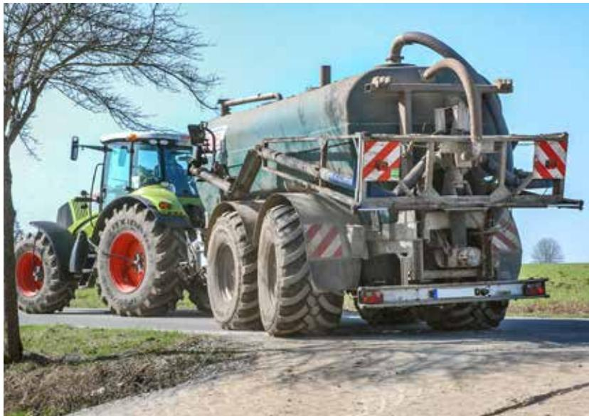
Tiefe Anhängung am Kugelkopf, aktive Zwangslenkung anstelle passivem Nachlauf der Lenkachse, große und breite Reifen mit variablem Reifendruck sind aktueller Stand der Fahrwerkstechnik am gut genutzten Güllefass.
